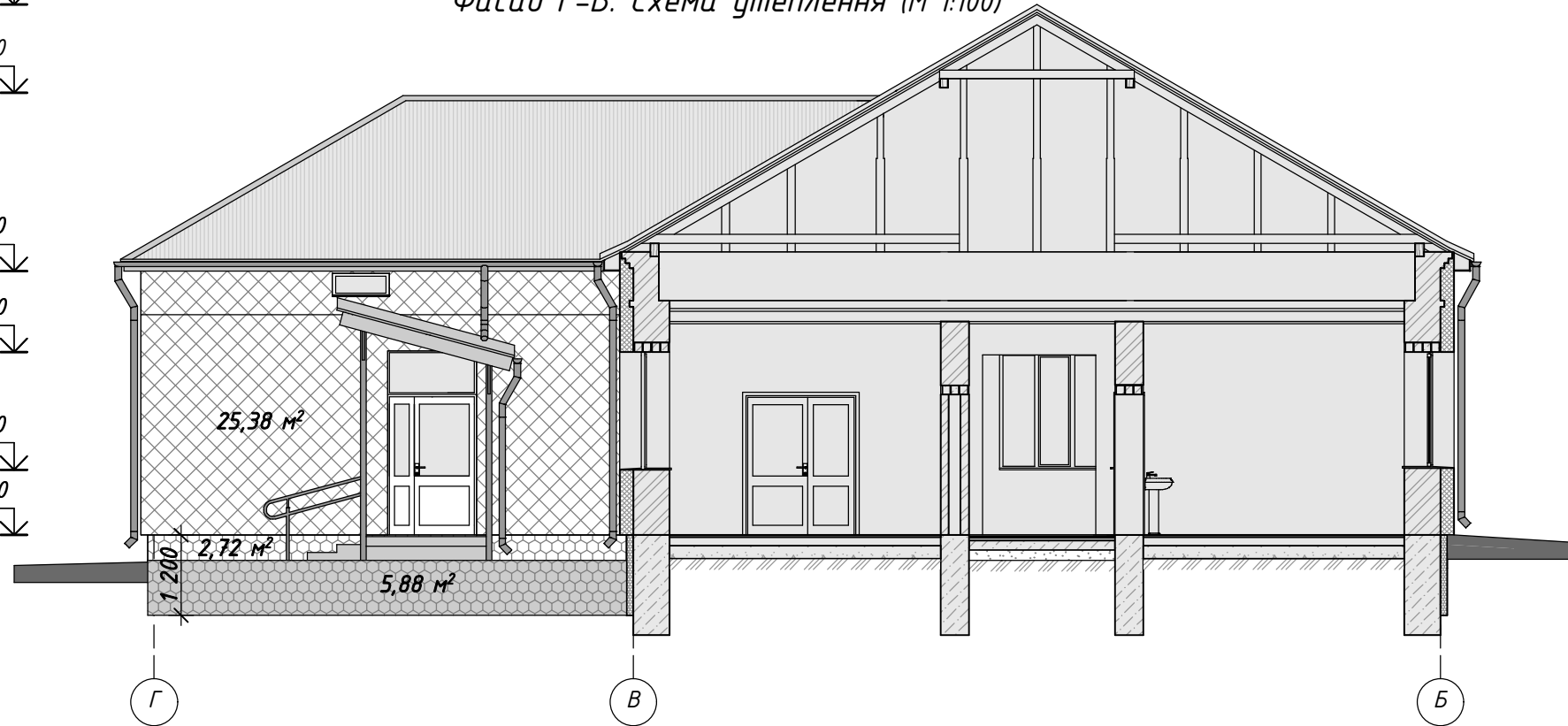
Фасад Г-Б. Схема утеплення (М 1:100)
